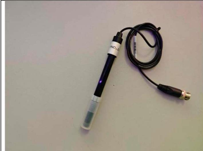
Датчик ионов хлора
