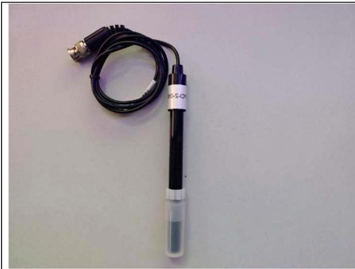
Датчик ионов хлора
