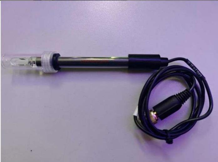
Датчик электрической проводимости
