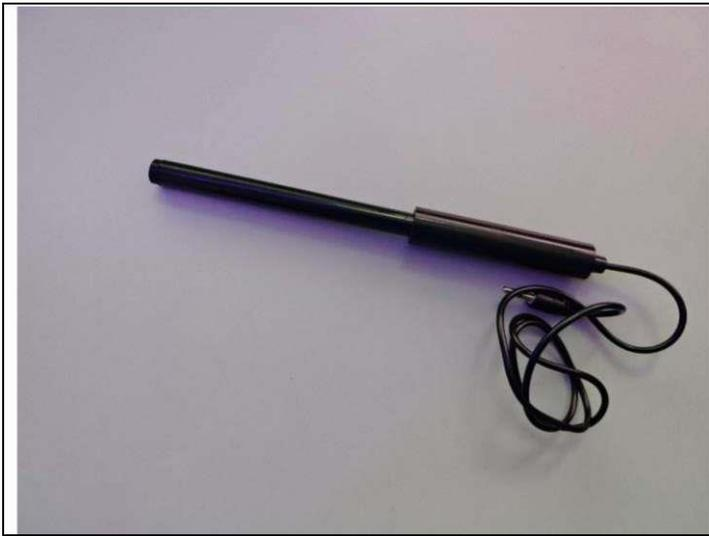
Датчик магнитного поля
